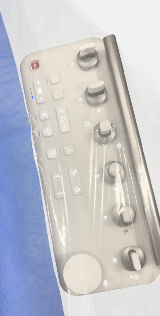
fóliová vložka na ochranu ovládacího panelu
